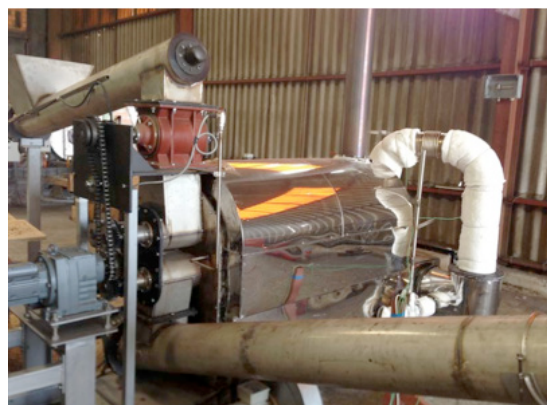
Carbonisateur Pyrochar-1 produisant du biochar
